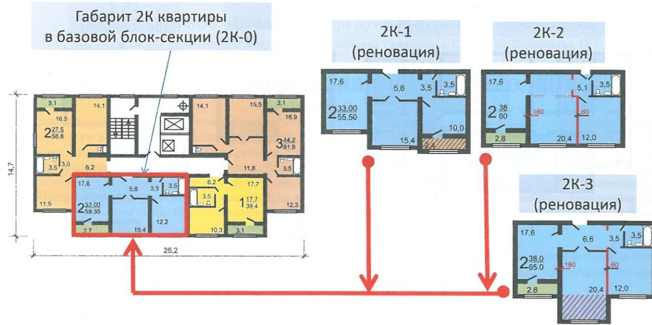
Рис. 2. Взаимозаменяемые «привязки» трех вариантов 2К квартир в базовой гибкой блок-секции «Дом НАД» (квартирография по условиям реконструкции)
