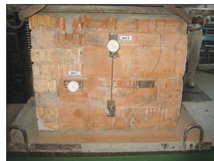
Рис. 3. Фрагмент каменной кладки в процессе испытания на сжатие. Образец № 2
