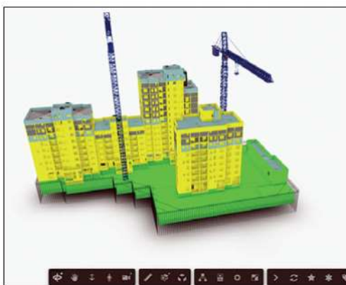
Рис. 7. Строительная модель пилотного объекта с цветовой индикацией статусов работ относительно сводной аналитической календарной модели
